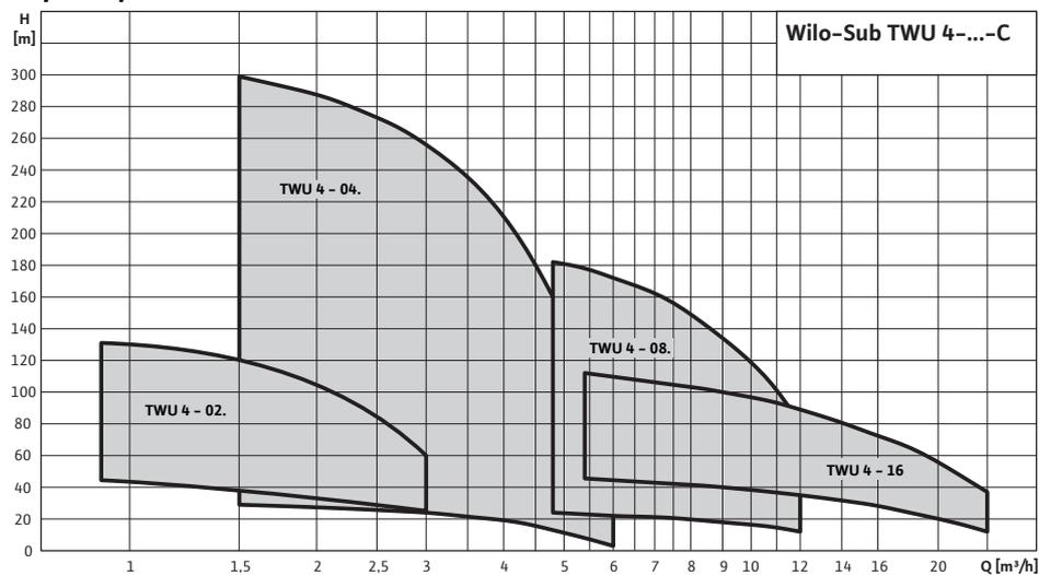
1~230 В или 3~400 В, 50 Гц,  $\rho = 1 \text{ кг/дм}^3$ ,  $\nu = 1 \times 10^{-6} \text{ м}^2/\text{с}$ , ISO 9906 приложение А,  $\eta = \text{КПД}$  насоса
